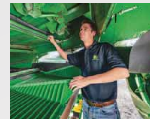
Легкость доступа Разбрасыватель половы легко складывается и обеспечивает доступ к системе зерноочистки. Теперь можно легко снять элементы зерноочистки, если это требуется для уборки кукурузы.
